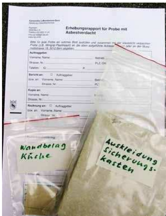
Placer chaque échantillon dans un emballage en plastique hermétique et y reporter la description ainsi que le lieu de prélèvement.
