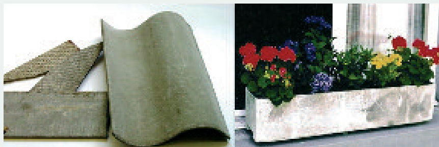
Abb. 2: Faserzementplatten und Blumenkiste mit festgebundenem Asbest
